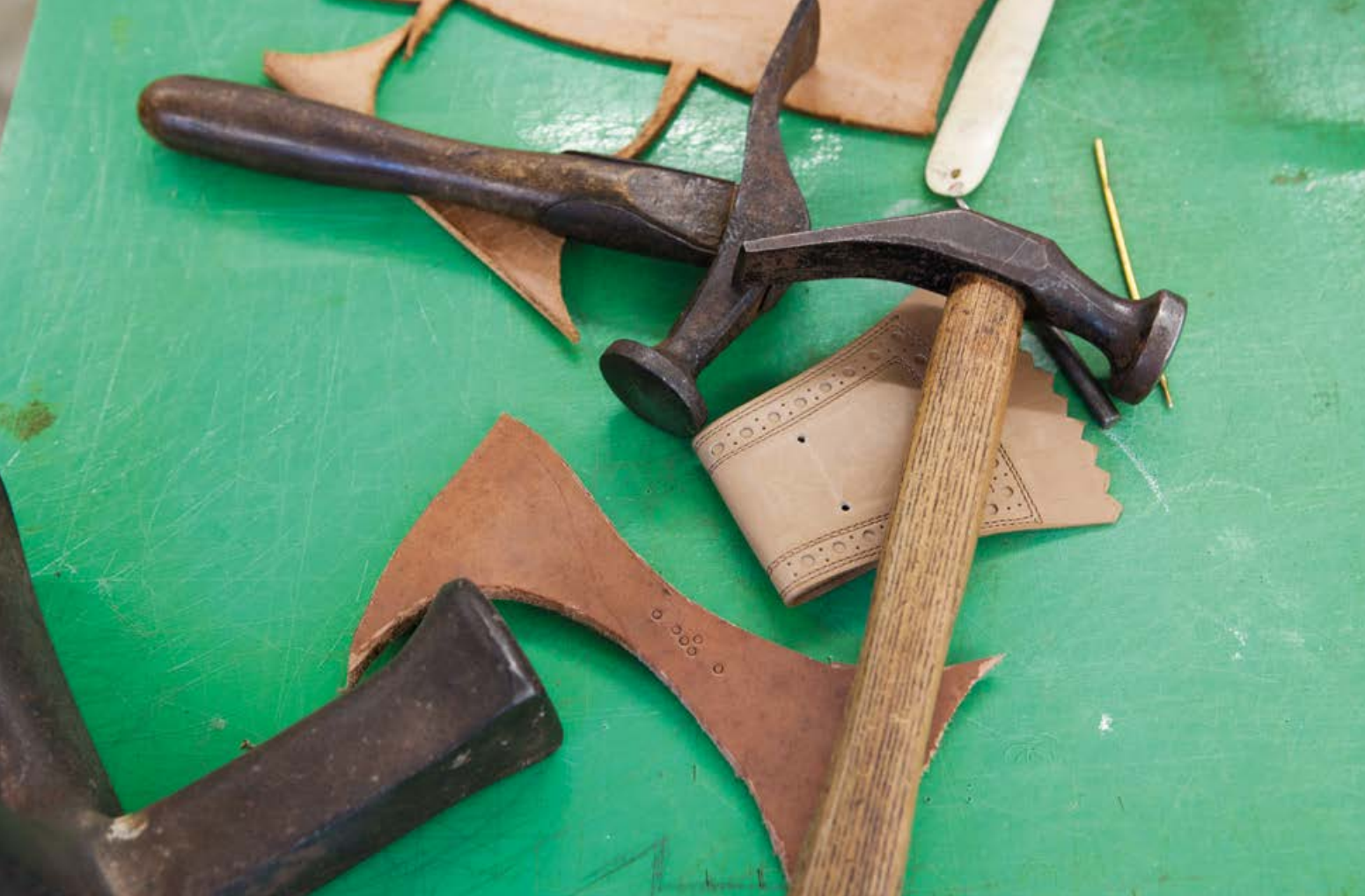
Hämmer, Silberstift, Spitzknochen zum Falzen, Biegen, Polieren und Knicken, Lochpfeife für Ösen oder Verzierungen, Sohlenleder und Golferlasche / Hammers; silver point; pointed horn for folding, bending, polishing and kinking; tool for perforating eyelets or embellishments; sole leather and golf shoe flap Unten: Modell-Schablonen für den Oberleder-Zuschnitt / Below: Templates for cutting uppers. Rechts: Abgeklebter Herrenleisten: Modellentwurf eines Derbys / Taped last with sketched lines for crafting a men's Derby model
