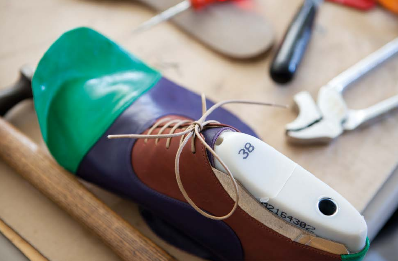
Schuh-Prototyp, Zwickzange zum Ziehen des Schafts über den Leisten, Tacksheber zum Rausziehen der Nägel, Rundahle und Hammer / Shoe prototype; lasting pincers for pulling the upper over the last; tack puller for pulling out nails; round awl and hammer Unten: Modell Palermo multicolore / Below: The Palermo multicolore model
