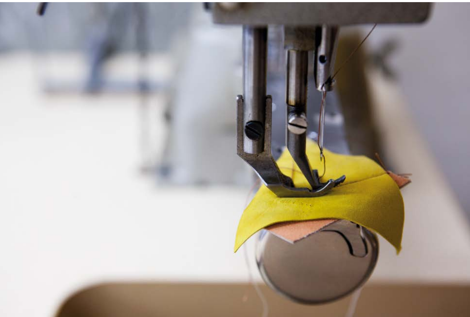
Sohlenfräser und Poliereisen zur Sohlenbearbeitung. Photo: ein rahmengenähter Schuh wird eingestochen / Machine for trimming and polishing the soles. Photo: a welted shoe is being pierced. Unten: Detail einer Freiarm-Ledernähmaschine / Below: Detail of a free-arm leather sewing machine
