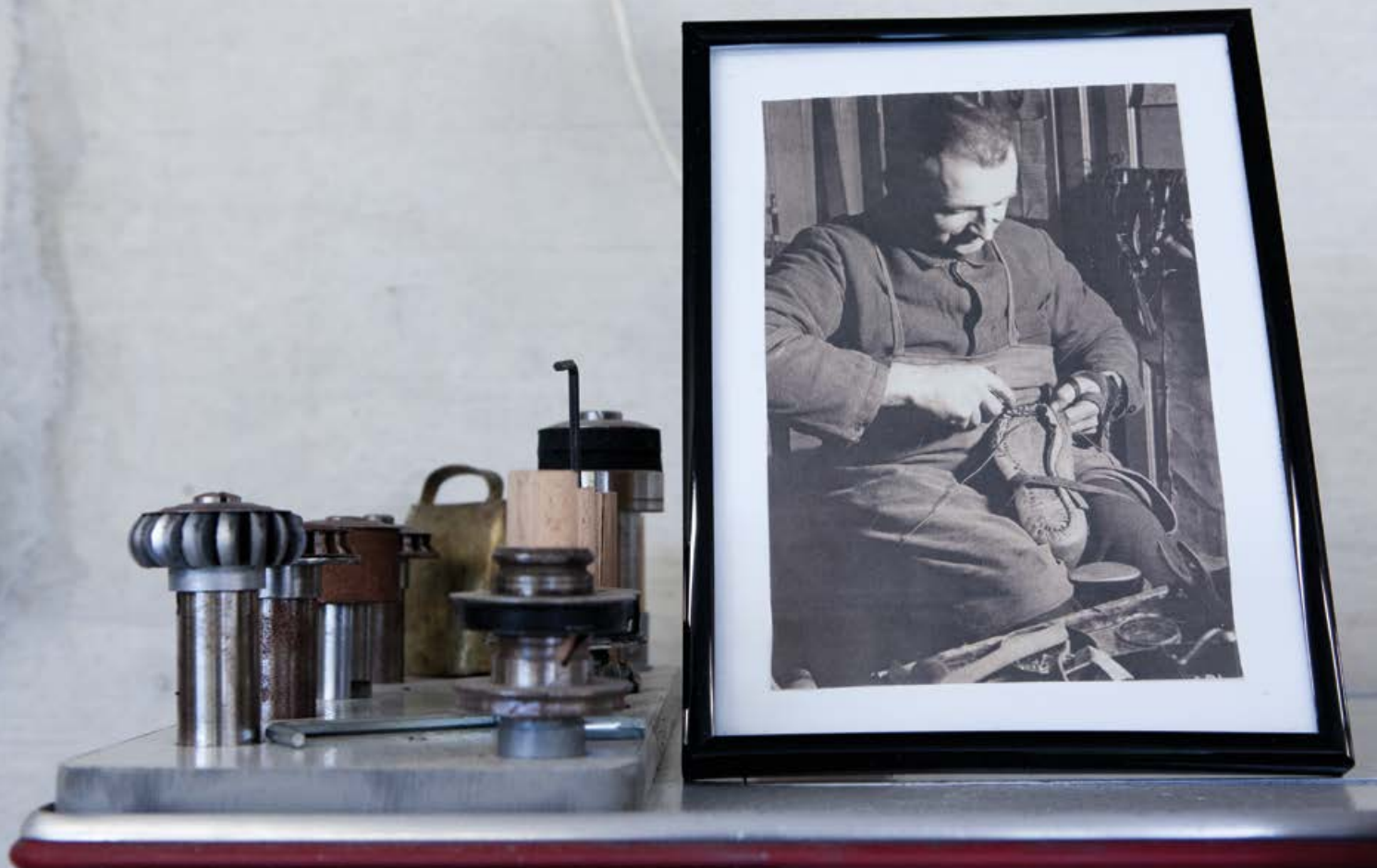
Sohlenfräser und Poliereisen zur Sohlenbearbeitung. Photo: ein rahmengenähter Schuh wird eingestochen / Machine for trimming and polishing the soles. Photo: a welted shoe is being pierced. Unten: Detail einer Freiarm-Ledernähmaschine / Below: Detail of a free-arm leather sewing machine
